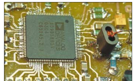
Bild 2: Da nicht alle Pins des DDS-IC AD9858 benötigt werden und viele nebeneinanderliegende Pins gleiche Bedeutung haben, entschärft sich das Lötproblem etwas.
