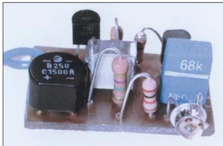
Bild 1: Der Fototransistor in der Triggerschaltung ist stets auf den Hauptblitz auszurichten. Foto: Regnilde
