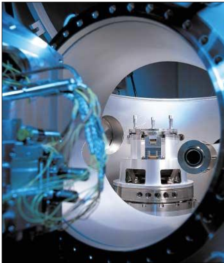
Bild 3: Vakuumkammer eines EUV-Beleuchtungssystems für künftige Lithographiesysteme zur Halbleiterproduktion
