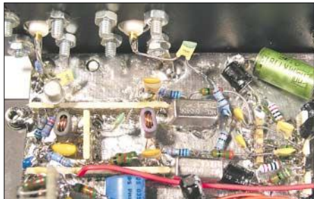
Bild 8: Detailansicht des Quadratur-Hybrids im Mustergerät Fotos: DL7MAJ
