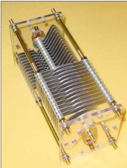
Bild 7: Doppeldrehkondensator zweimal 230 pF/4 kV Fotos: DK7ZB
