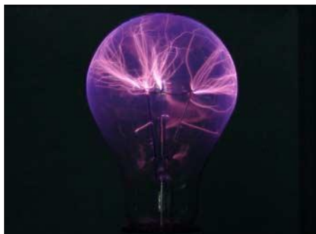
Bild 1: Eine 200-W-Glühlampe kann auch als Plasmakugel dienen.
