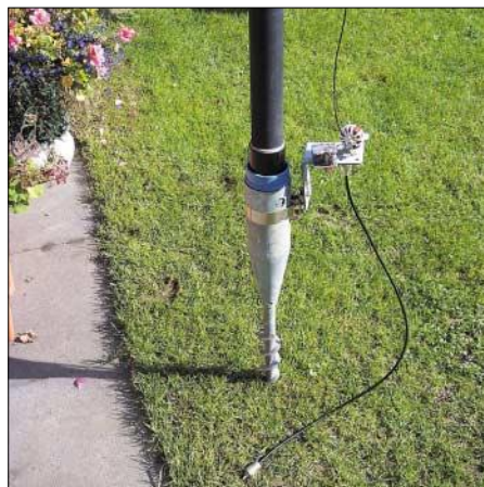
Bild 13: Ein Wäscheständerschraubfuß trägt Glasfasermast und Fuchskreis. Fotos: DF1EO
