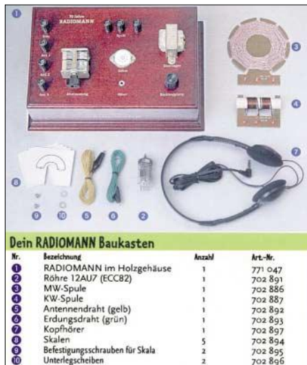
Bild 7: Einzelteilesatz der Neuauflage Fotos: Franckh-Kosmos Verlags-GmbH
