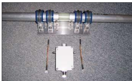
Bild 1: Montageplatte des Rotary-Dipols einschließlich Balun, noch demontiert
