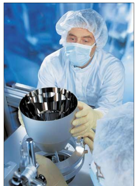
Bild 2: Optik der Zukunft – Spiegelsystem für das Muster eines EUV-Belichtungssystems für kommende Chip-Generationen
